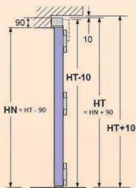
Sezione verticale 1 e 2 ante con telaio tubolare
