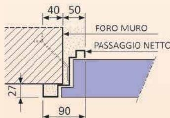
Dettaglio del telaio tipo "Z"
