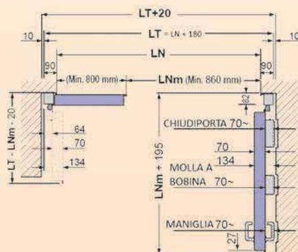
Sezione orizzontale 2 ante con telaio tubolare
