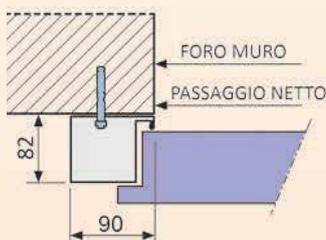
Dettaglio del telaio tipo "tubolare"
