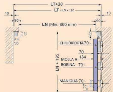
Sezione orizzontale 1 anta con telaio tubolare
